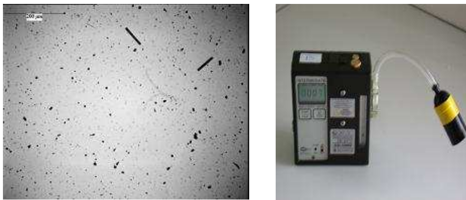
Figure VI-6 : Exemple de dispositif utilisé pour la capture sur filtre des particules et observation au microscope du filtre préalablement rendu transparent (Grossissement x 250, surface 500 \mu\text{m}^2 ).
