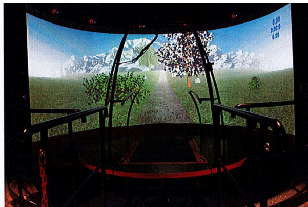
Figure 59 : Illustration d'un écran semi-cylindrique offrant 180° de champ visuel horizontal placé face à un tapis roulant.
